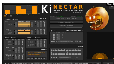
Figur 10: Kinectar. Mjukvaran Kinectar används för att koppla samman mänskliga gester med MIDI-kontrollers eller MIDI-mjukvara (från Vik 2012).
