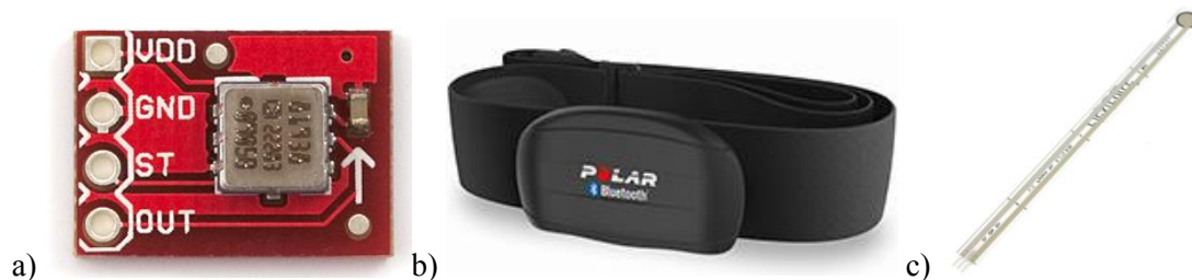
Figur 3: a) Accelerometern ADXL193 från Analog devices. Enheten mäter ungefär 1.5 \text{ cm}^2 . b) Pulsmätare Wearlink+ från Polar Electro. c) Barometer från Tekscan, Inc. Den runda delen mäter tryck.
