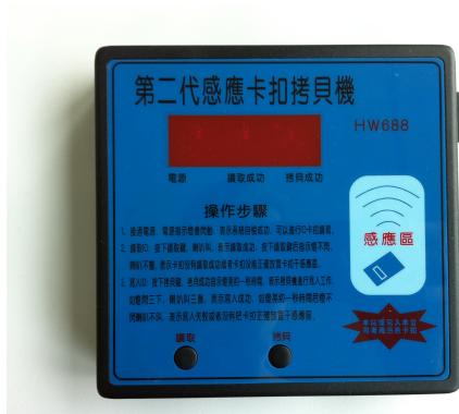
Figur 5: Kopieringsapparat för 125kHz-taggar
