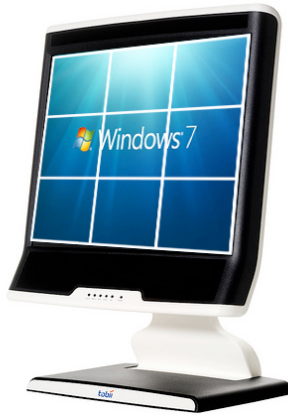
Fig 11: En eyetracker som känner av i vilket av de nio fälten du tittar. Bild från www.tobii.com . Redigerad i Adobe Photoshop.
