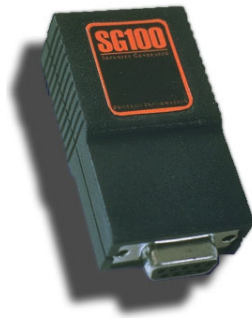
Figur 3.1. SG100, hårdvarubaserad TRNG, Protego Information AB, pris. 249 euro.
