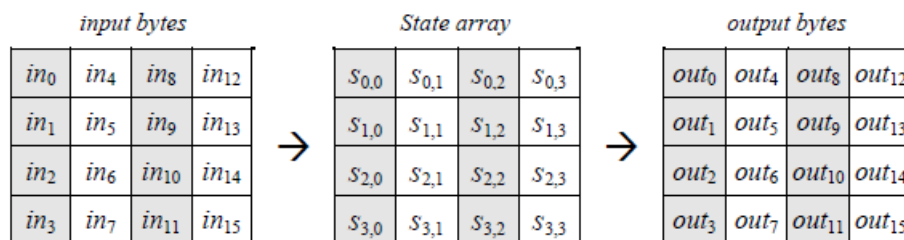
Figur 4.5. Inmatning av meddelandetext till S -matrisen som i slutskedet överför den krypterade meddelandetexten till en utdatamatrix. Källa: Federal Information Processing Standards Publication 197, NIST
