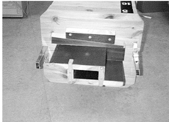
Fig. 9. Uppe till vänster ses lådan från baffelsidan med Peerlesselementet monterat. Plattan med elementet kläms fast med en kil. Uppe till höger ses lådans baksida med 20cm-porten monterad. Porten består av två L-formade bitar som kan skjutas relativt varandra och på så sätt uppnås en variabel tvärsnittsarea. Porten är utbyttbar och kläms fast med en kil. Nere till vänster är en låda på 5+16+8+5 = 34 liter. Lådan skruvas ihop med två limknektar längs sidorna. Överst i bild ses basreflexporten.
