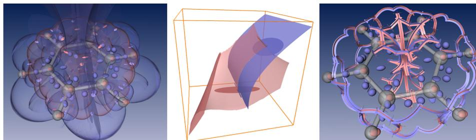
(a) Topologisches Skelett mit Separationsflächen. (b) Sattelkonnektor als Schnittkurve zweier Separatrizen. (c) Topologisches Skelett mit Sattelkonnektoren.
