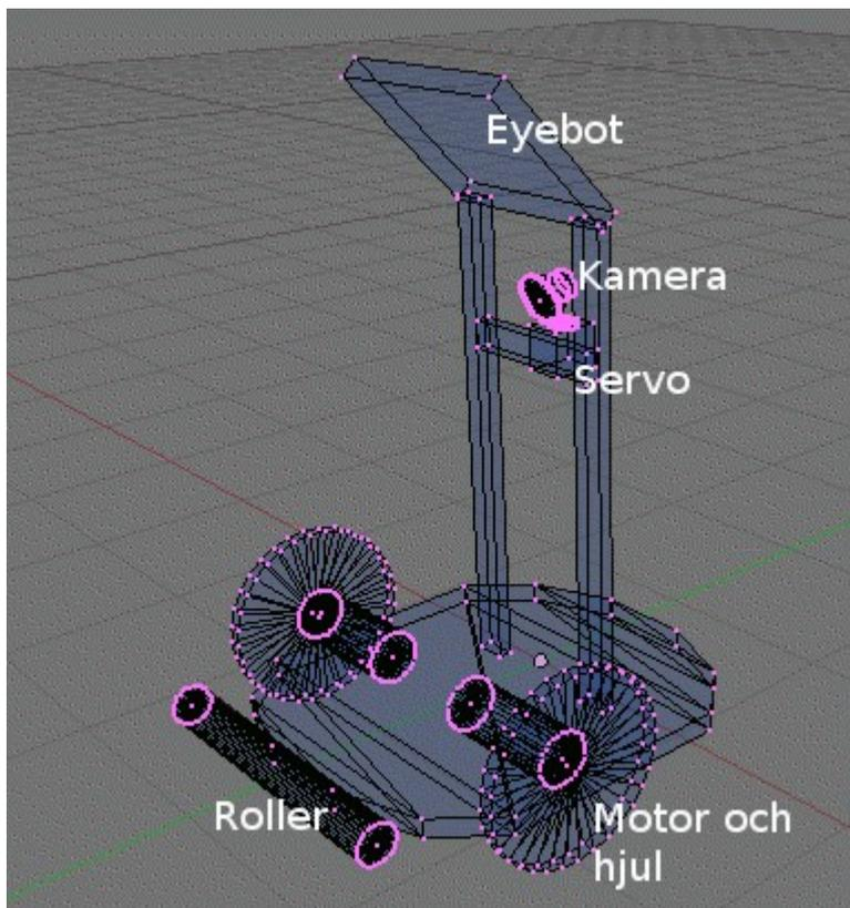
Robotens konstruktion var enkel. Inledningsvis användes ett litet hjul som bakre stöd, men då det på ett tidigt stadium visade sig att detta förorsakade en markant manövreringsproblematik, konstruerade kursens labbassistent Anders ett temporärt substitut i form av en fasttejpädd sked. Det visade sig att denna nödlösning passade utmärkt. Så några ytterligare modifieringar, som kunde leda till framtida eventuella manövreringsfiaskon, var det givetvis inte tal om.
