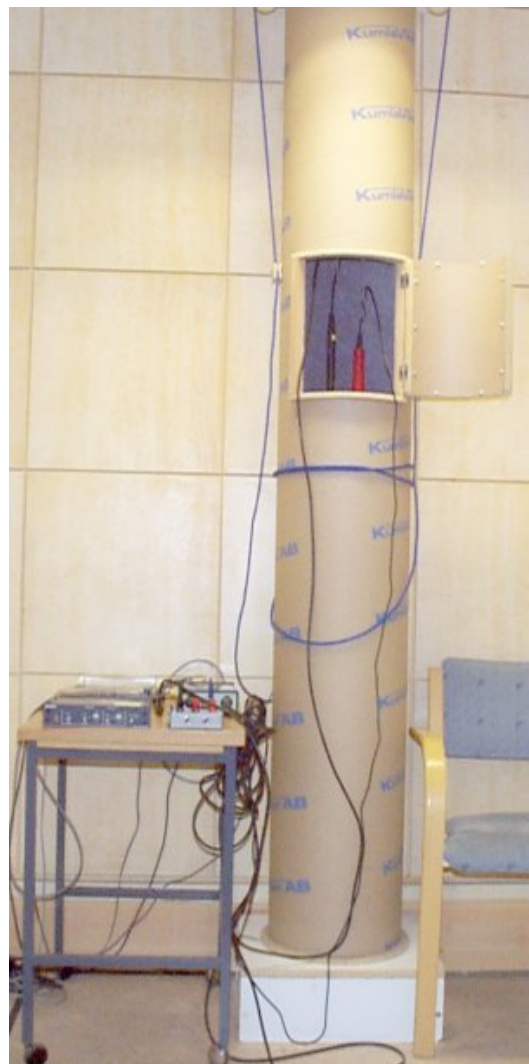
Fig 1. Mättunneln. I röret åstadkoms en plan våg, nerifrån och uppåt, med hjälp av en högtalare i vardera ändan av röret och en fördröjning
