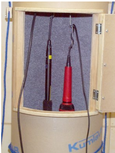
Fig 2. Två mikrofoner inhängda i mättunneln. Luckan stängs under mätningen
